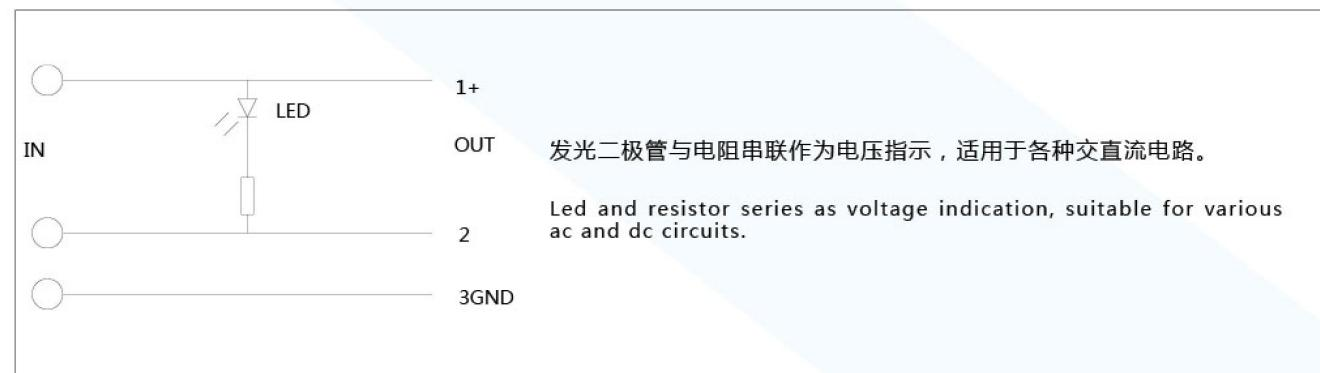
发光二极管与电阻串联作为电压指示，适用于各种交直流电路。
